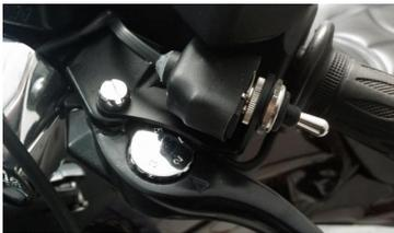
Der Taster für die Hupe wird an der linken Lenker- Armatur mit der Schraube vom Kupplungshebel montiert. Das Kabel vom Taster im Kabelkanal verlegen (Schrauben vom Kabelkanal nur lösen, nicht komplett herausdrehen). Das Kabel um den Lenkkopf herumführen und unter das linke Staufach führen. Den Stecker mit der 2 poligen Kupplung von der Schaltbox verbinden.
