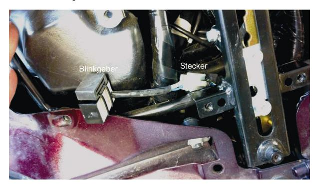
Nach dem anschließen des Blinkgebers die Funktion überprüfen. Die Blinker in den Rückleuchten sollten mit normaler Blinkfrequenz blinken.
